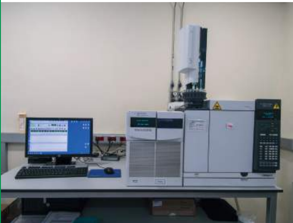
Equips destinats a l'anàlisi de mostres sòlides, d'esquerra a dreta, el CG-MSMS d'Agilent, el CG-MSMS de Bruker i CG-FID d'Agilent.
